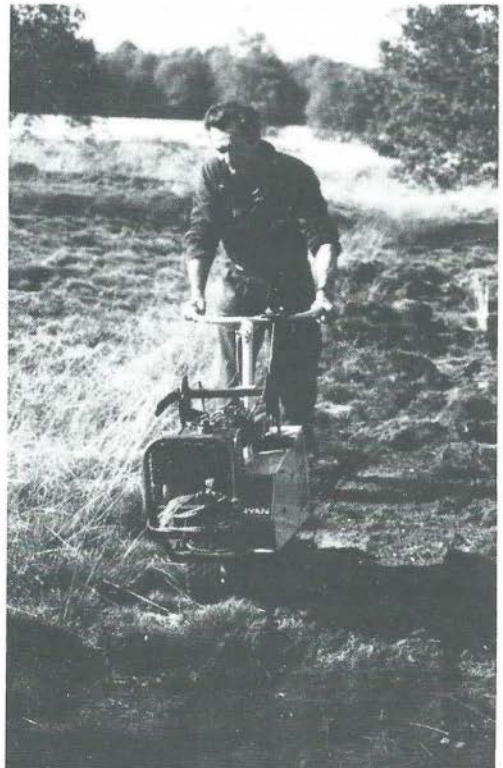
'Plaggen' met de graszoden snijmachine.
