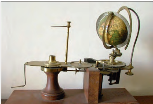
Tellurium uit het “National Inventory of Scientific Instruments” van Charles Mollan, Royal Dublin Society.
